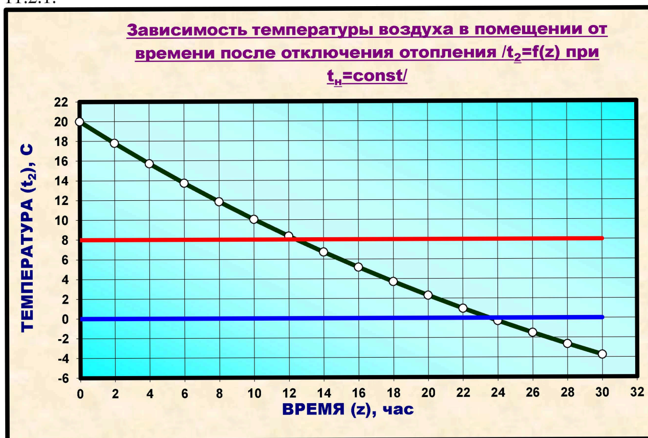
Рисунок 11.2.1 – Зависимость температуры воздуха в помещении от времени после отключения отопления при наружной t_{\text{наруж.}} = -100^{\circ}\text{C}
